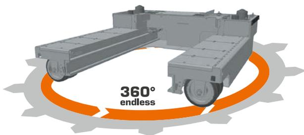
Grazie al moderno sistema sterzante HUBTEX HX, disponibile in optional, è possibile passare dal senso di marcia laterale alla marcia frontale senza doversi fermare. Questo riduce la tempistica del cambio direzione delle ruote e ne riduce l'usura.
